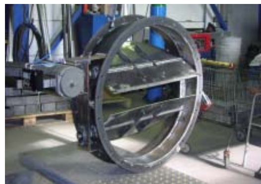
Reglerspjäll, motgående blad DN 900 mm
