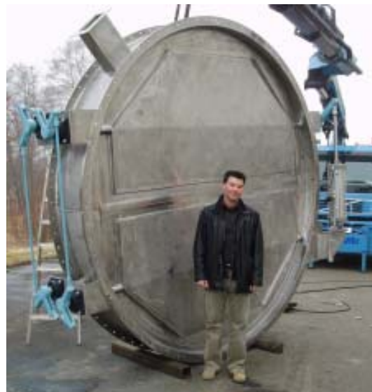
Dubbelspjäll med uttag för spärrluft DN 3200 mm
