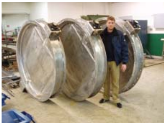
1-axlat DN 1700 mm material: 2343
